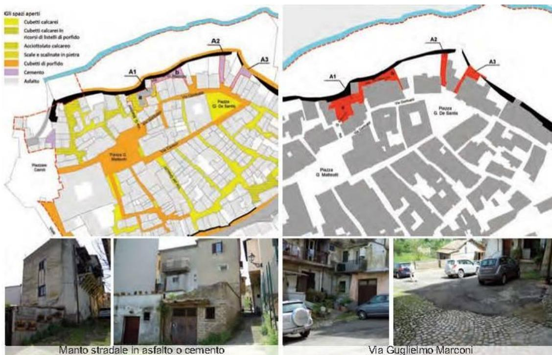
Fig. 6.1 - Proposta per intervento sulle pavimentazioni incompatibili e degradate
