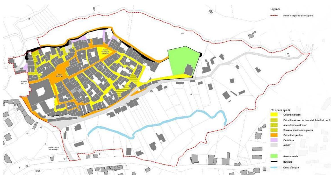
Fig. 4.2 - La rete degli spazi pubblici e delle pavimentazioni
